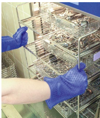
Рисунок 7. Разгрузка стеллажа с очищенными и продезинфицированными изделиями из моюще-дезинфицирующей машины. Стеллаж и корзины горячие требуют использования персоналом средств индивидуальной защиты.
