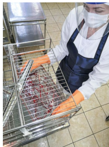
Рисунок 4. Загрузка стеллажа с МИ в моюще-дезинфицирующую машину.
